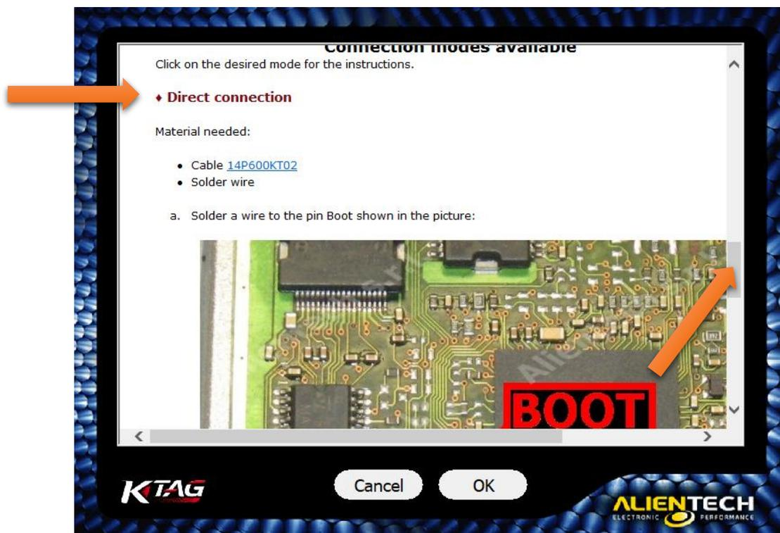
6.往下拉，找到接线图和 BOOT 点，接好线，点 OK
